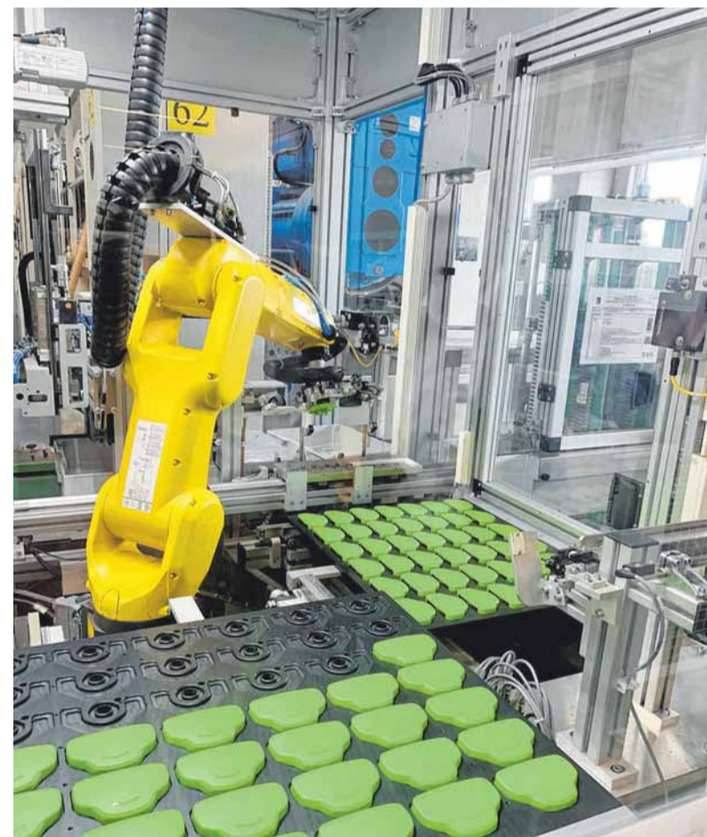
So sieht Qualitätskontrolle aus: Der gelbe Roboterarm greift je ein grünes und graues Bauteil, kombiniert sie und hält sie vor eine Kamera, um zu prüfen, dass auch alle Maße stimmen und funktionieren. FOTO: CHRISTOPH SCHNEIDER
